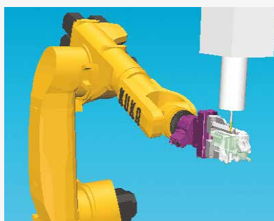
Entgraten. Das Werkstück kann direkt am Roboterarm montiert werden.
