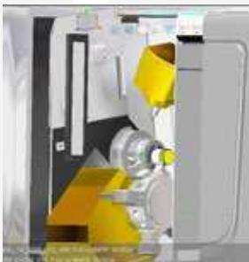
Der Viewer simuliert die CNC-Maschine auf Basis des tatsächlichen NC-Codes und stellt die reale CNC-Maschine virtuell auf dem Schreibtisch dar.
